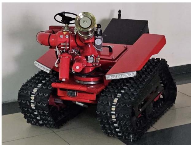
Рисунок 3 – Опытно-экспериментальный образец многофункционального автономного беспилотного наземного аппарата на гусеничном ходу с установленным дистанционно управляемым пожарным лафетным стволом
