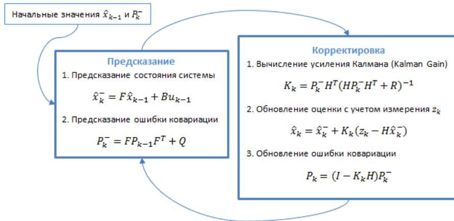
Рисунок 2 – Алгоритм работы фильтра Калмана.
