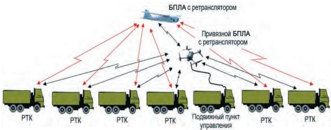
Рисунок 3 – Групповое применение РТК (транспортного типа) по доставке материальных средств (вариант)
