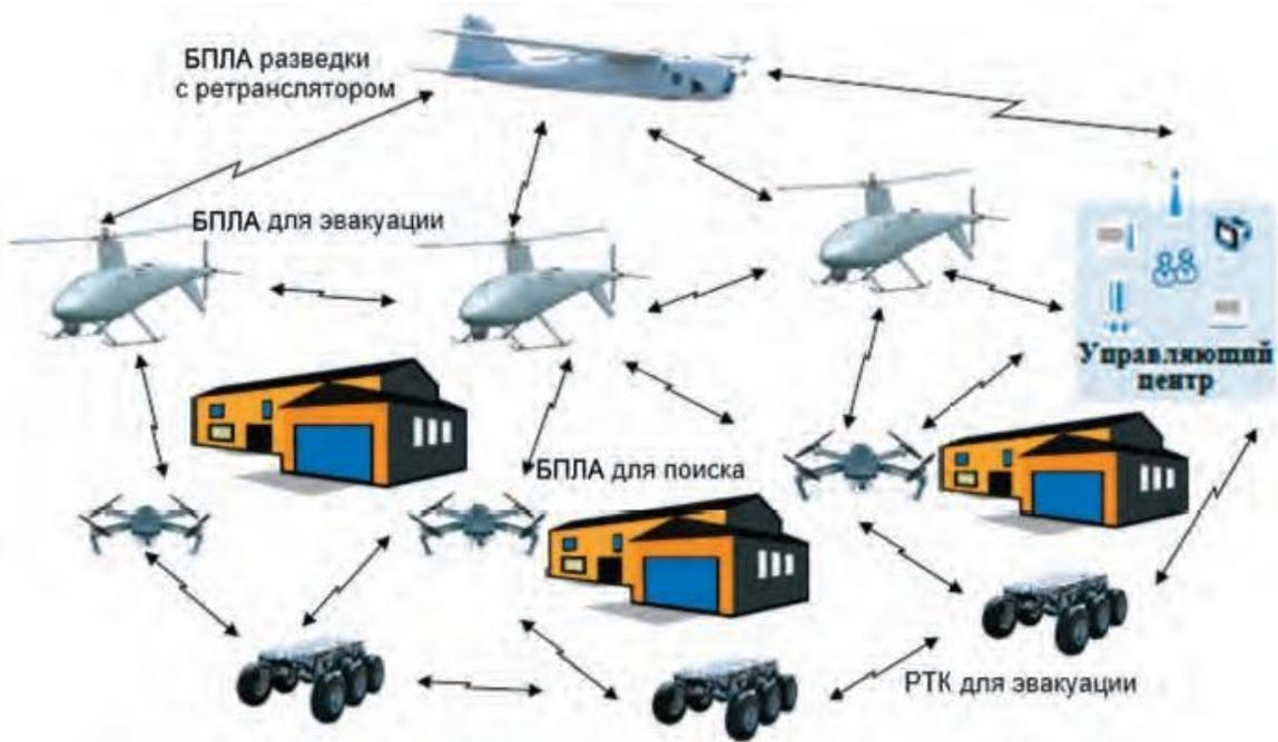
Рисунок 4 – Групповое применение РТК для поиска и эвакуации раненых и больных (вариант)
