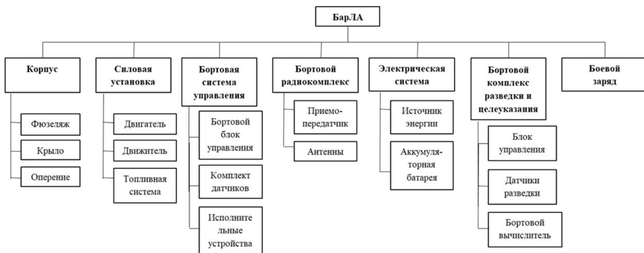
Рисунок Б.8 – Структура типового барражирующего БПЛА
