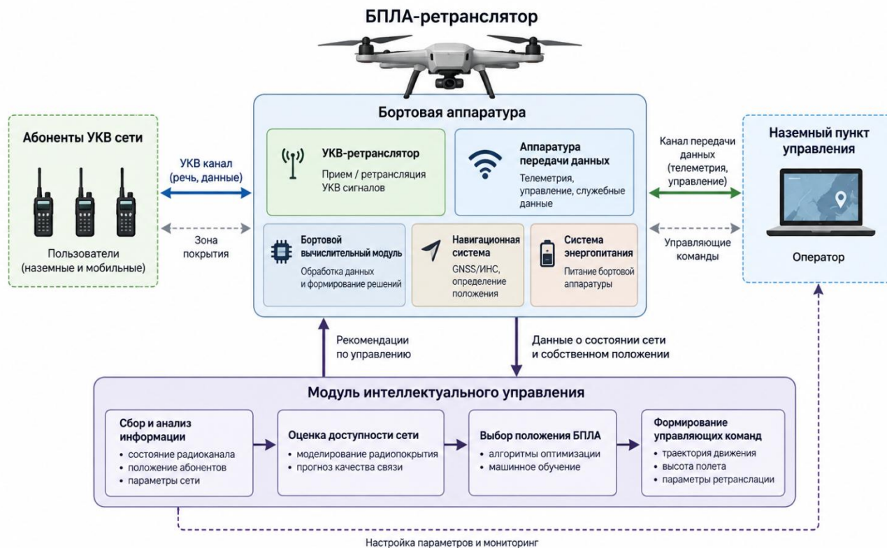
Рисунок 1 – Функциональная архитектура интеллектуальной системы радиосвязи с применением БПЛА-ретранслятора
