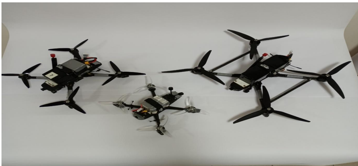
Рисунок 3 – модификации FPV дрона «Ара»
