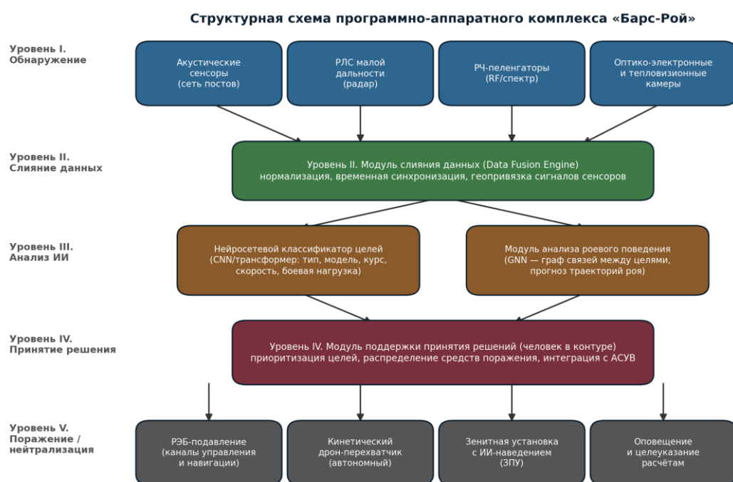
Рисунок 1 – Структурная схема программно-аппаратного комплекса «Барс-Рой» (составлено автором)
