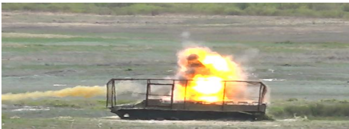
Рисунок 4 – результаты боевого применения FPV дрона «Ара» с боевой частью 9М14П в режиме «камикадзе» по бронеобъекту на удалении 1200 метров
