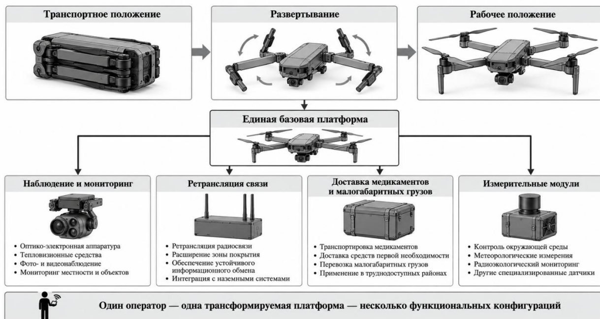
Рисунок 1 – Концептуальная схема многофункционального БПЛА трансформируемой конструкции
