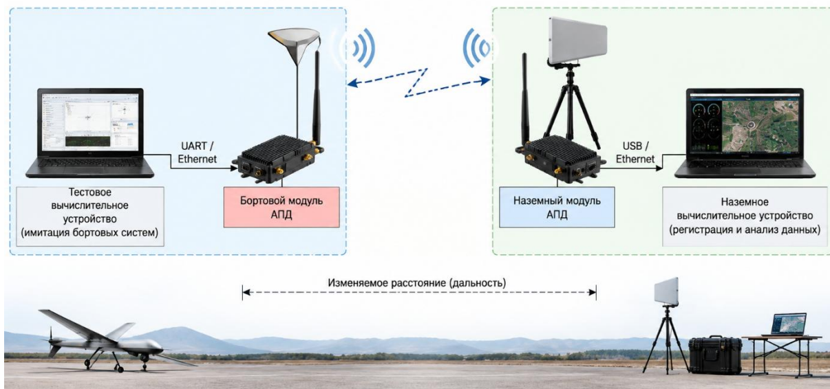
Рисунок 2 – Структура экспериментального стенда исследования АПД
