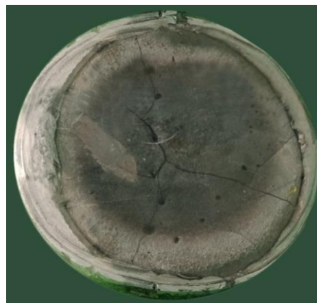
Рисунок 8.8 – Кинетическая диаграмма усталостного разрушения (а) [8]; сплав CrNiTiZrCu перед разрушением (б)
