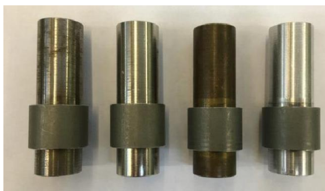
Рисунок 1.13 – Муфты из сплава TiNiFe одинаковой высоты, собранные со стержнями из различных материалов [9]
