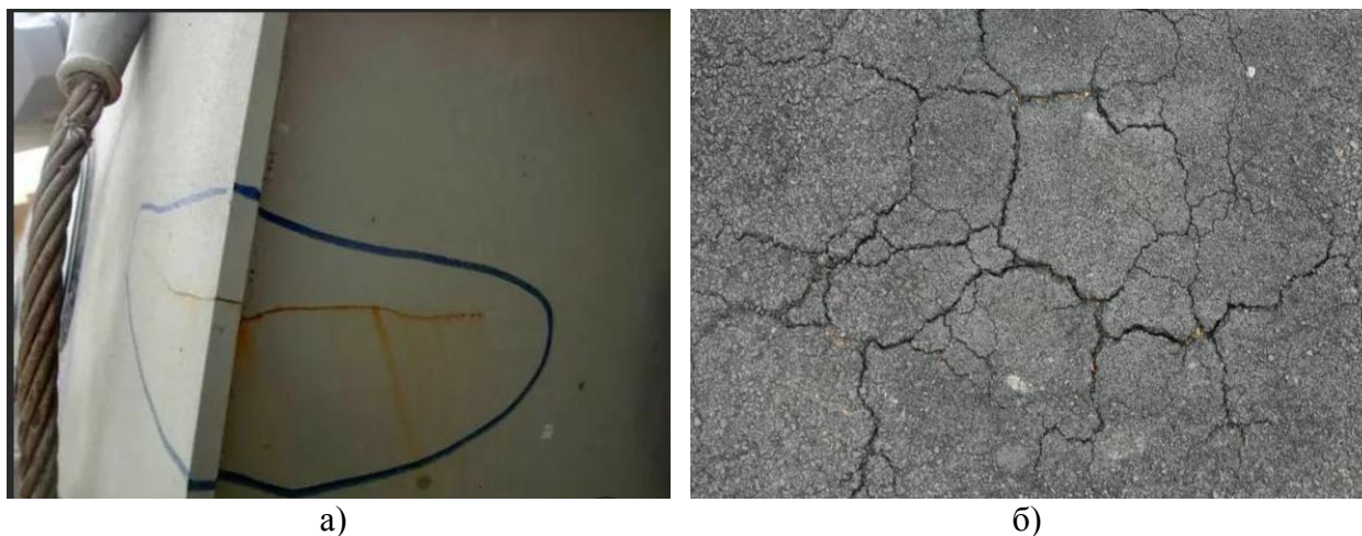
Рисунок 9.1 – БТР и трещина на корпусе (а); танк с трещиной бронекорпуса (увеличение 400 раз) [9]
