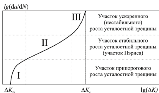
Рисунок 8.8 – Кинетическая диаграмма усталостного разрушения (а) [8]; сплав CrNiTiZrCu перед разрушением (б)
