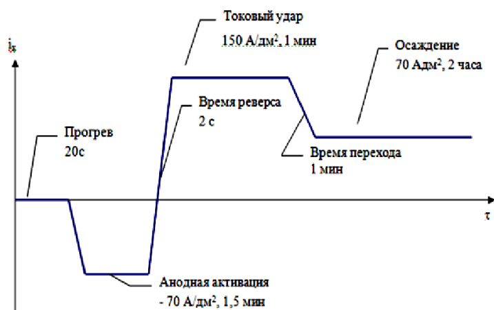
Рисунок 3.23 – Изменение плотности тока в процессе хромирования [13]
