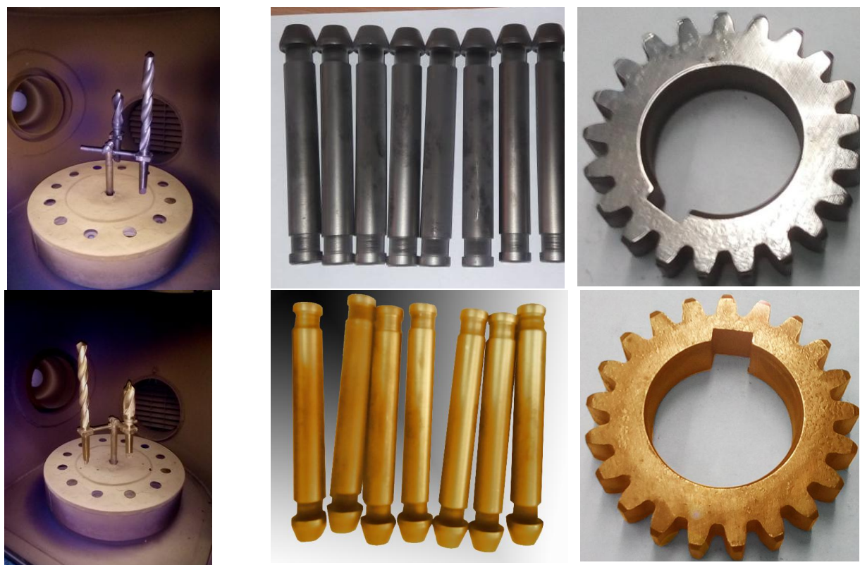
Рисунок 7.51 – Детали до (сверху) и после нанесения покрытий (снизу)
