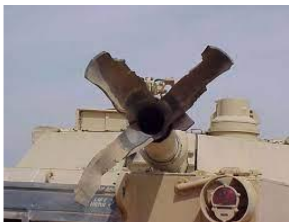
Рисунок 8.29 – Разрыв стволов пушек у танков
