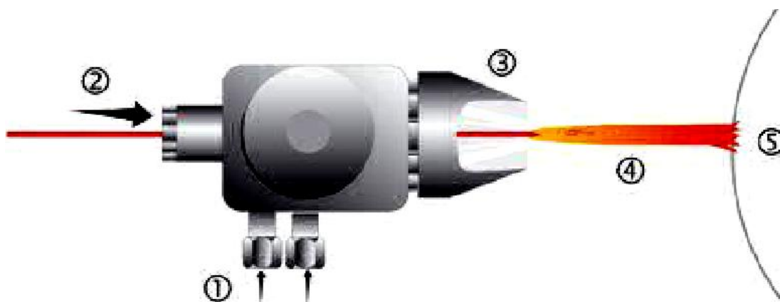
(1) Ацетилен/Кислород (2) Проволока или стержень (3) Сопло (4) Ацетилен/кислородное пламя и напыляемый материал (5) Деталь
