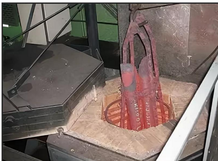
Рисунок 3.15 – Установка электролизного силицирования [7]
