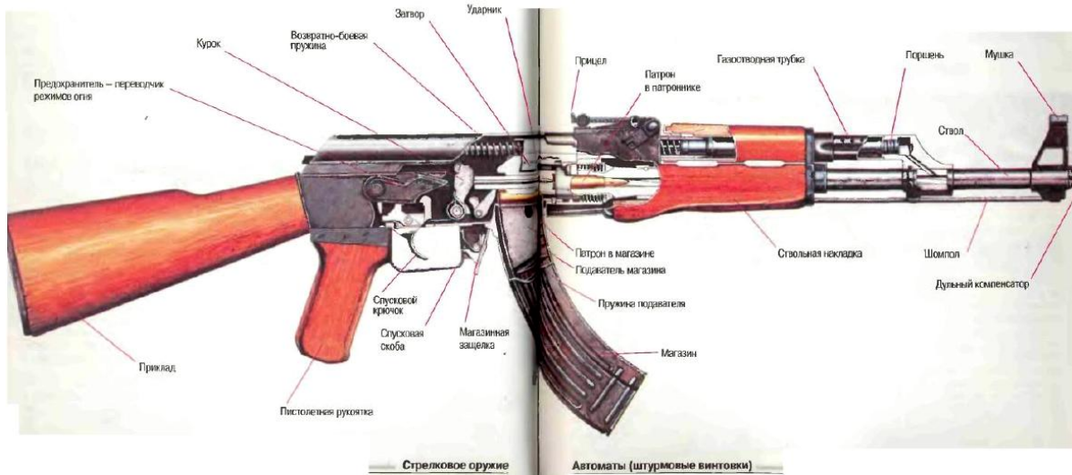
Рисунок 3.26 – Автомат АК-47 с обозначением деталей для хромирования [10]
