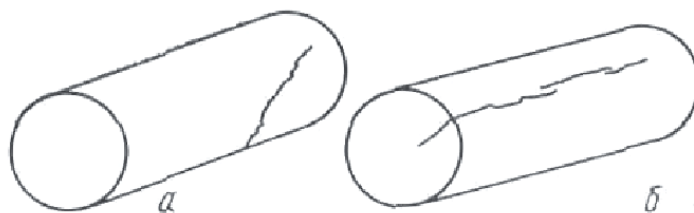
а – единичная трещина; б – прерывистая продольная трещина
