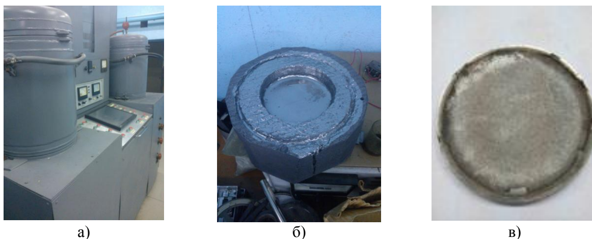
Рисунок 8.2 – Двухколпачковая вакуумная печь (а), графитовая форма для плавки металла (б), вид мишеней CrNiTiZrCu, полученных методом вакуумной плавки (в)
