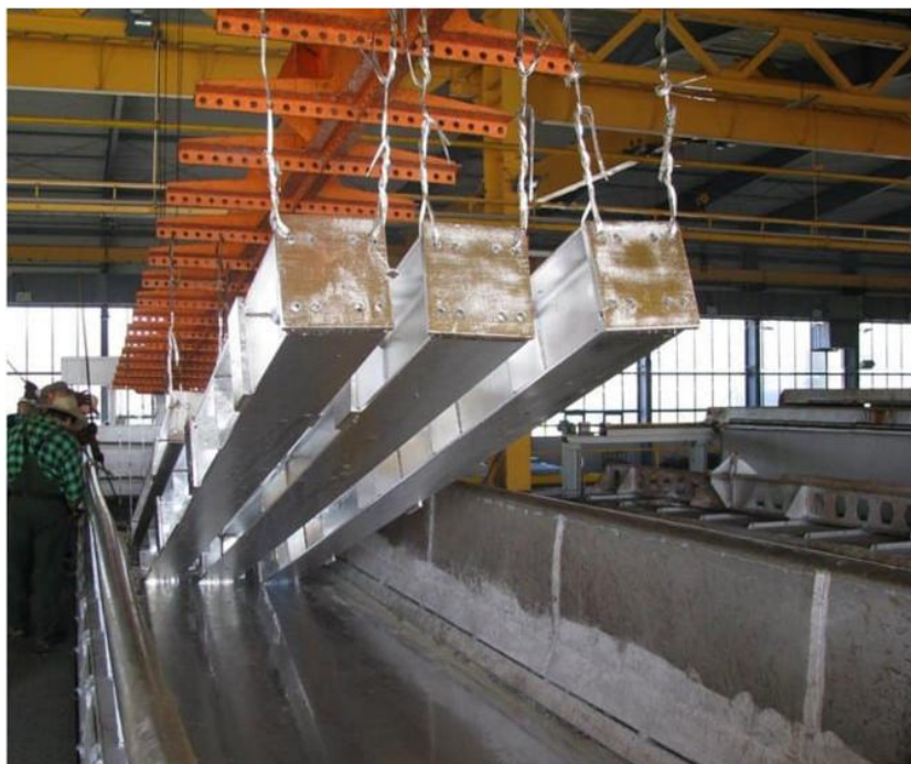
Рисунок 3.27 – Технология горячего цинкования [15]
