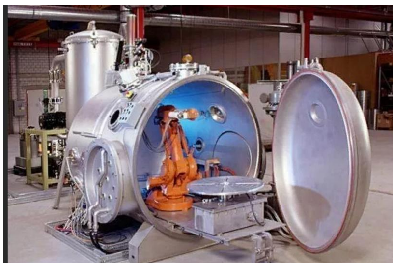
Рисунок 3.22 – Алитирование в вакууме [8]
