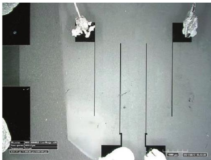
Рисунок 1.43 – Резонансный акустический датчик графен/YZ-срез кристалла \text{LiNbO}_3 [23]
