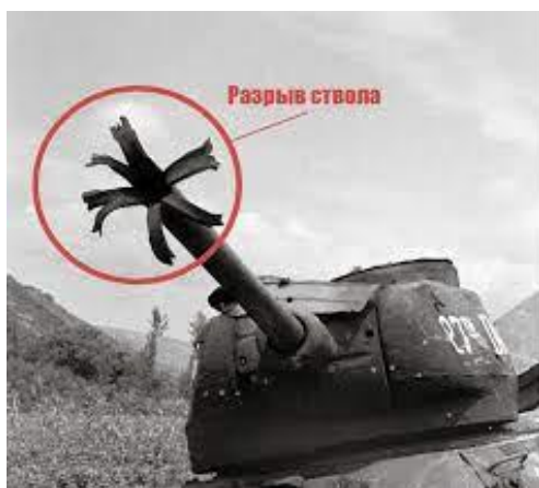
Рисунок 8.29 – Разрыв стволов пушек у танков
