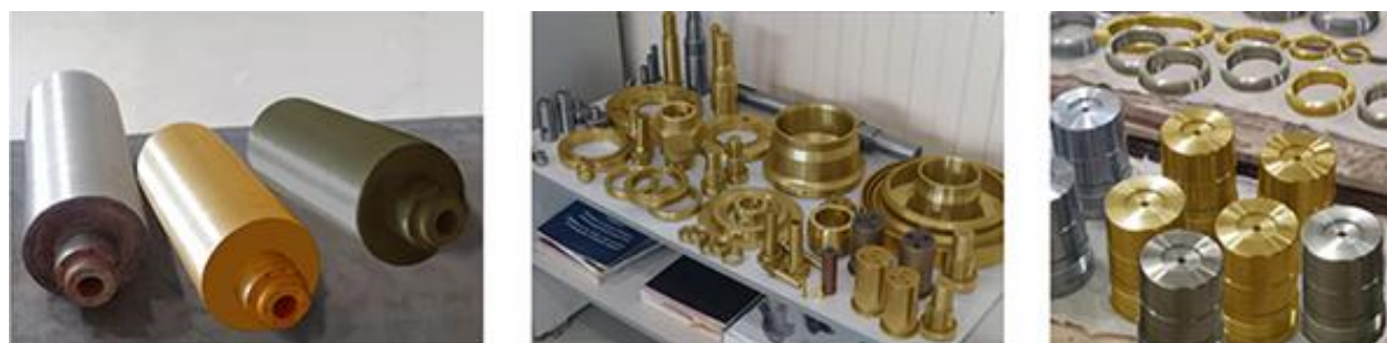
Рисунок 9.29 – Детали ГРШО с ИПМ – покрытием и ХГН – покрытием
