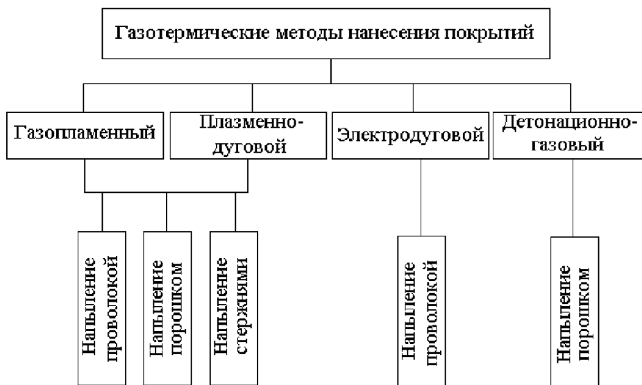
Рисунок 3.32 – Классификация способов газотермического напыления по форме напыляемого материала [1]
