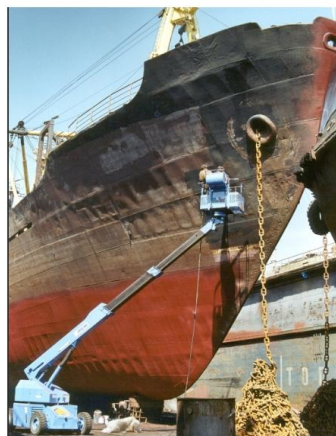
Рисунок 9.25 – Ржавый корабль (а); нанесение лакокрасочных покрытий на судно (б)
