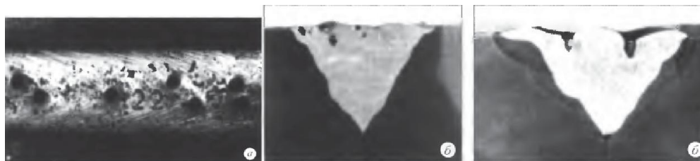
Рисунок 9.24 – Поры в сварном шве: а – выходящие на поверхность (внешний вид); б – не выходящие на поверхность (макроструктура); в – свищи (макроструктура) [31]
