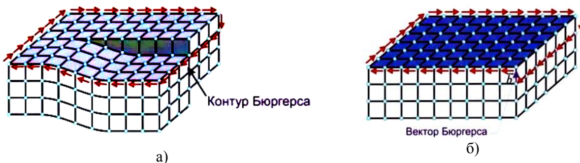
Рисунок 5.7 – Контур Бюргера (а); вектор Бюргера (б) [2]
