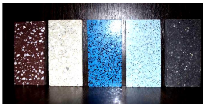
Рисунок 1.23 – Внешний вид образцов архитектурно-декоративного бетона с полированной поверхностью [18]
