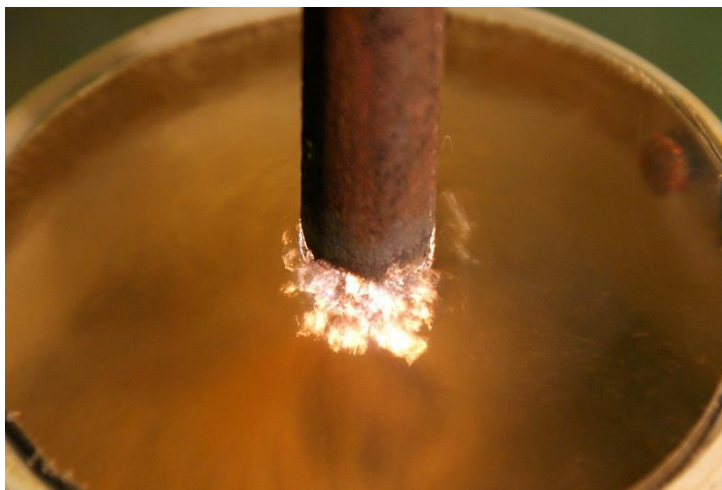
Рисунок 3.4 – Цементация в жидкой среде [2]
