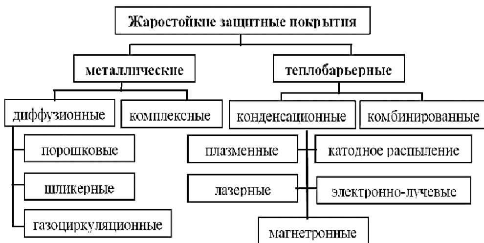
Рисунок 9.17 – Классификация защитных покрытий и методов их нанесения
