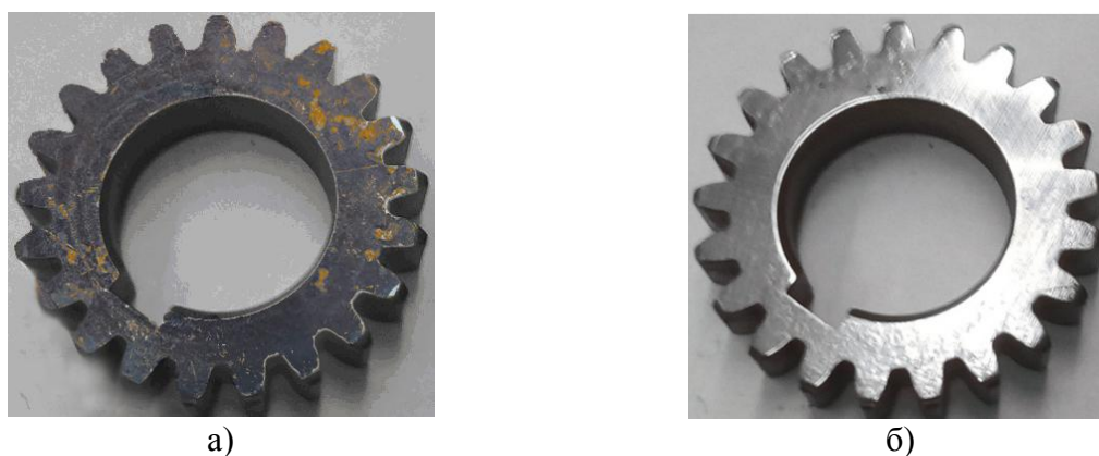
Рисунок 9.42 – Шестерня, подвергнутая коррозии (а); шестерня с ХГН-покрытием (б)
