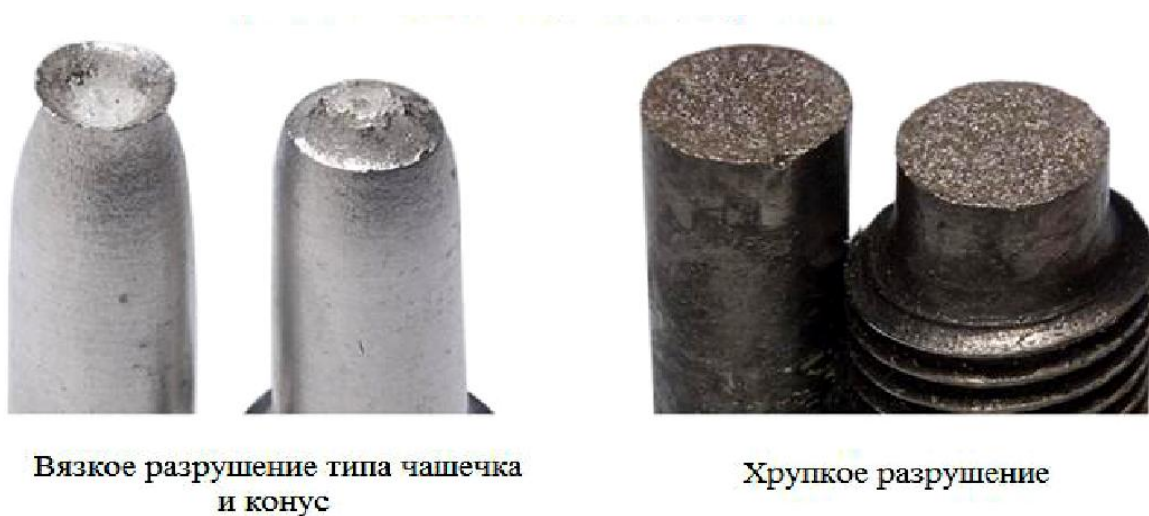
Рисунок 5.29 – Поверхности разрушения цилиндрических образцов из вязкого и хрупкого металлов [32]
