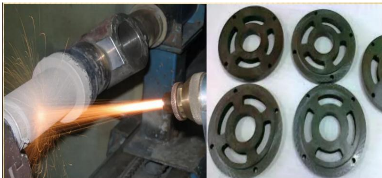
Рисунок 3.18 – Силицирование при использовании газовой смеси [7]
