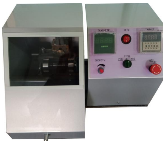
Рисунок 2.10 – Внешний вид прибора автоматизированного определения толщины и износостойкости покрытия
