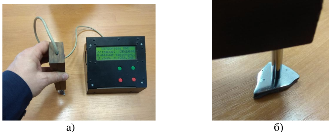
Рисунок 3.9 – Измерение прибором «Поверхность-11» (а), расположение датчика на образце (б)
