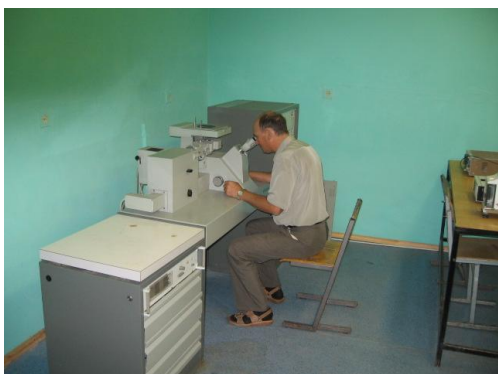
Рисунок 2.3 – Микроскоп «Эпиквант» (а), снимки покрытия (x1000) (б)
