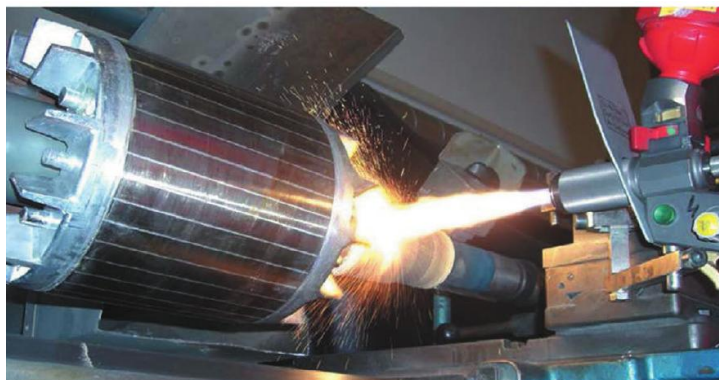
Рисунок 1.31 – Газопламенное напыление, материал – порошок
