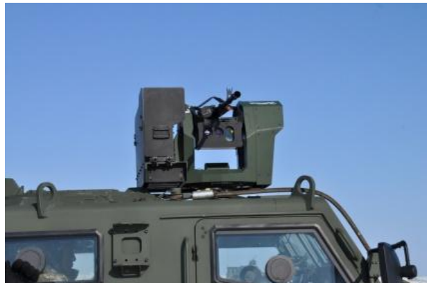
Рисунок 3 – Боевой модуль «Сарп», установленный на БРМ «Арлан»
