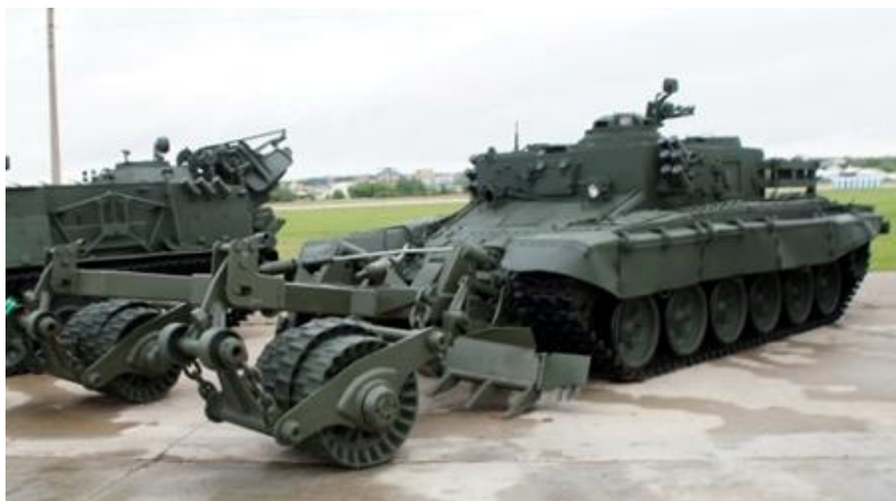
Рисунок 5 – Бронированная машина разминирования БМР-3М «Вепрь»
