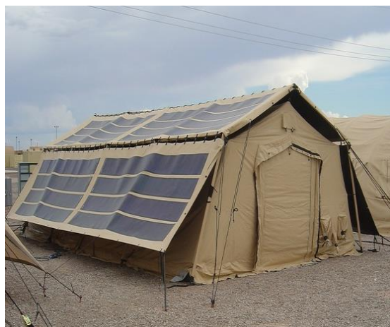
Рисунок 2 – Палатка с вшитыми солнечными панелями армии США
