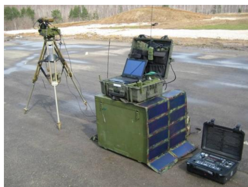
Рисунок 6 – Переносная электростанция типа ЭПС-120П
