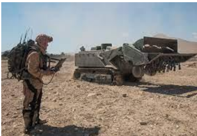
Рисунок 1 – Многофункциональный робототехнический комплекс разминирования Уран-6
