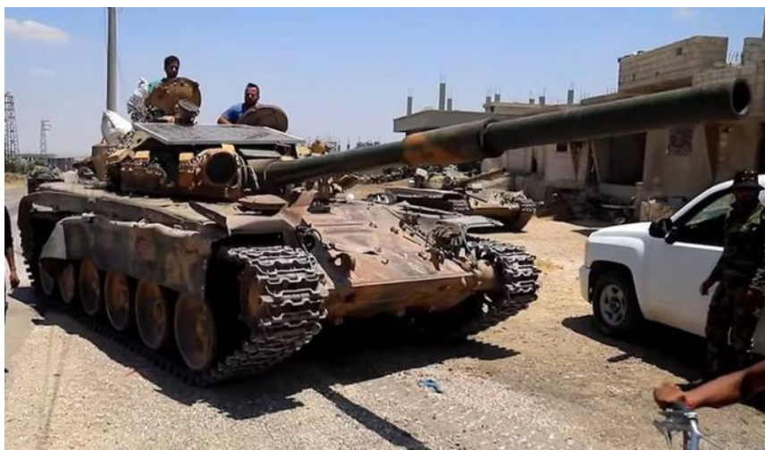
Рисунок 7 – Танк Т-72 сирийской армии с установленной солнечной панелью на башне
